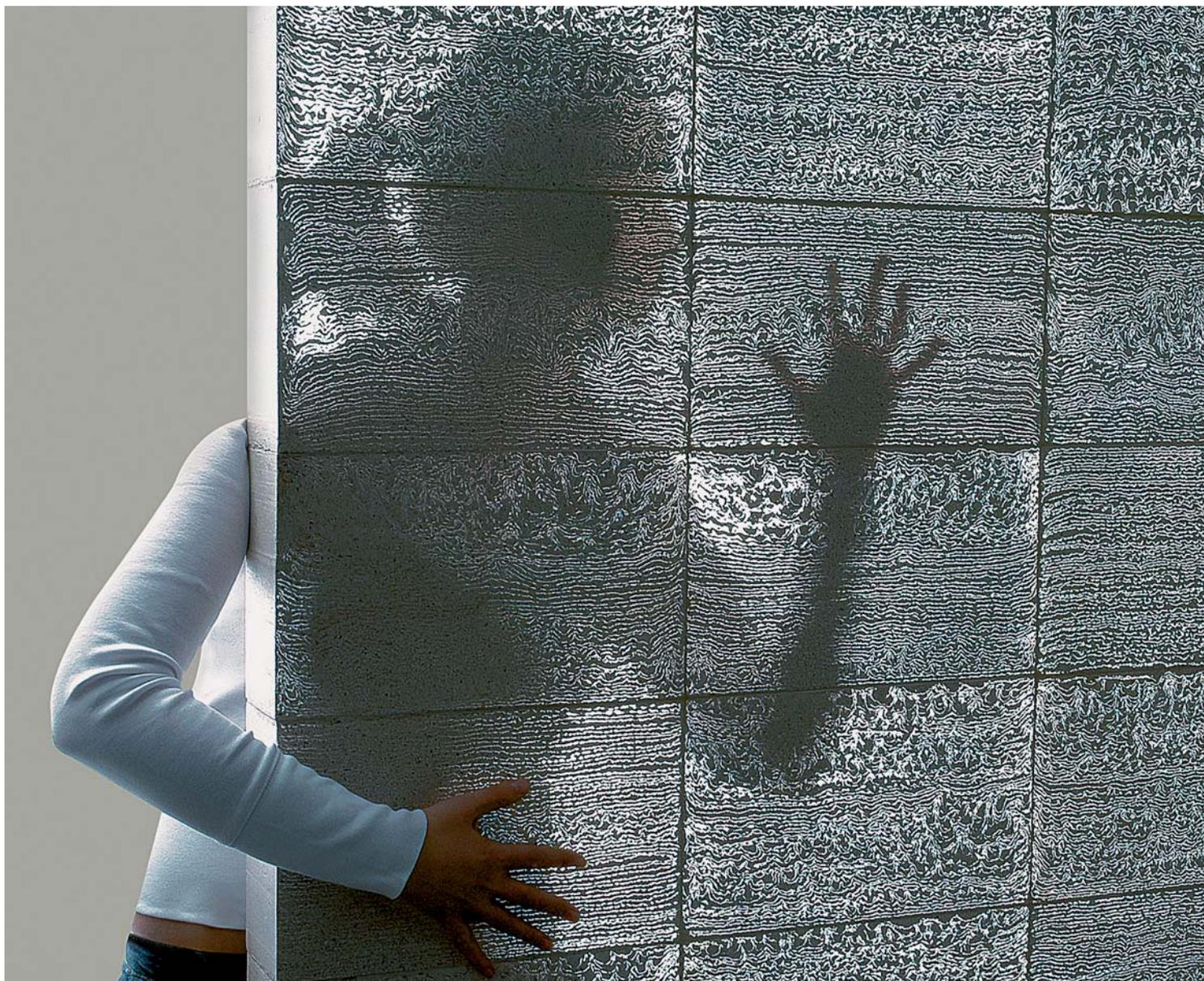
Lichtdurchlässiger Beton, Kombination aus Beton und Fiberglas; © Litracon Bt 2001–2007
